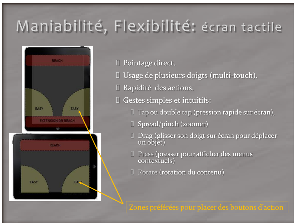
Figure 6 : Positions privilégiées sur la tablette pour le positionnement de boutons de commande (Saffer 2011).
